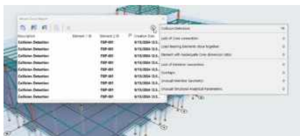
Рисунок 3. Виявлення колізій між елементами моделі
