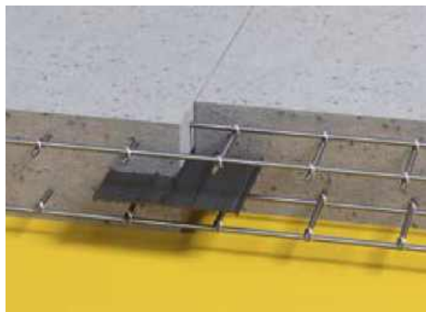
Рисунок 1. Приклад конструктивного рішення застосування внутрішньої гідрошпонки для герметизації швів у монолітних конструкціях
