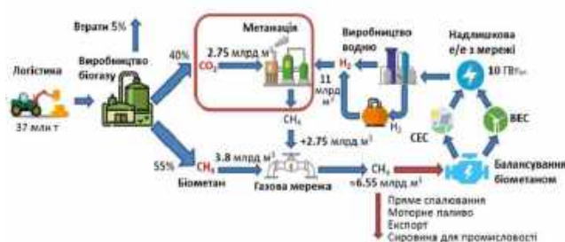
Рисунок 1. Принципова схема метанації вуглекислого газу [11]
