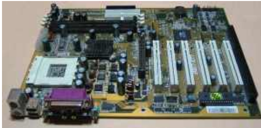
Рис. 2. Материнська плата формату ATX - AVIT KT7
